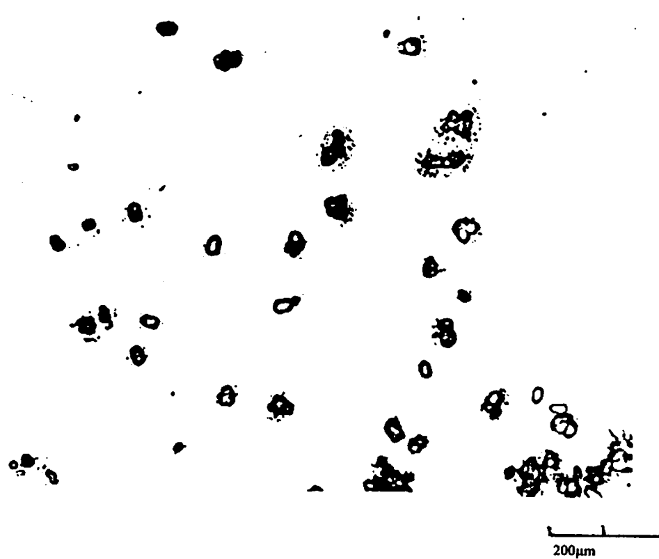
Abb. 6.: Morphologie der Kalkablagerung von den Heizstäben der Blindstrecke, welche mit unbehandeltem Speisewasser betrieben wurde
