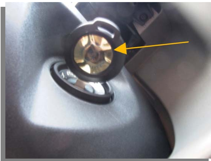
Der Chip wurde auf die Rückseite des Zündschlüssels geklebt.
