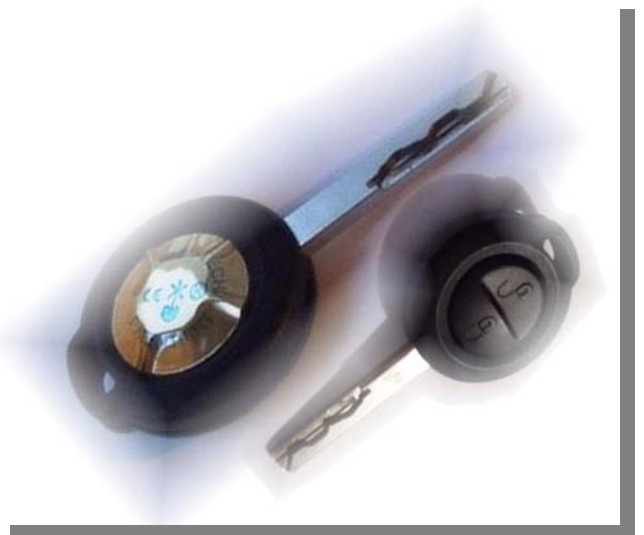
Der Chip wurde auf die Rückseite des Zündschlüssels geklebt.
